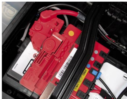
A pirotechnikai kábelmegszakító a jármű ütközésekor az akku pozitív sarkánál fejti ki hatását
