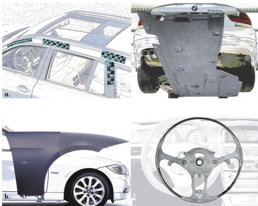
Néhány BMW-példa a könnyűépítésre, melyek könnyebbé teszik a kocsiszekrényt: a szerkezeti fémhab, a műanyag padlóburkolat (a), és oldalfal, a magnézium kormánykerék (b)
