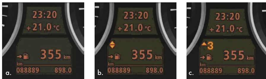
A kapcsolásjelző jelzéképe kikapcsolt (a), megfelelő fokozatba kapcsol sebességváltó (b), a 3-ik fokozatba való felkapcsolás megjelenítése (c) esetén
