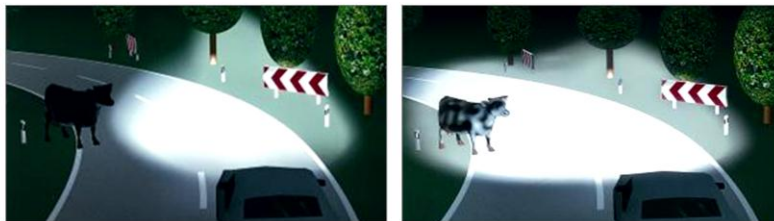
A dinamikus kanyarkövető fényszórók alkalmazásának lényege
