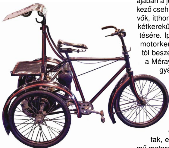
Csonka János tervei alapján készült motoros tricikli, a motor saját fejlesztésű karburátorral és nagyfeszültségű gyújtással (Közlekedési Múzeum)
