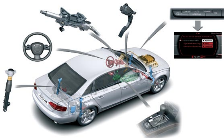
Az Audi A4-es Audi drive select elnevezésű működtetésvezérlő felügyelete alá tartozó részegységek
