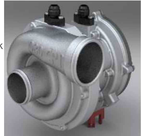
Elektromos hajtású Cobra (Controlled Boosting for Rapid Response Applications) szuper- feltöltő, 1:4 arányú maximális nyomásviszonnyal Forrás: Controlled Power Technologies
