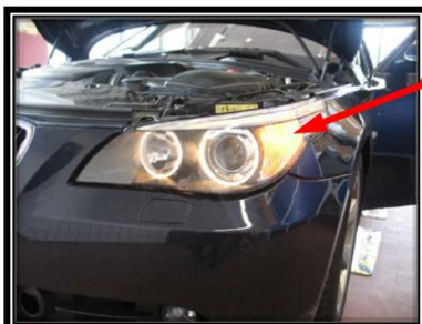
Irányjelző helyzetjelzőként bekötve
