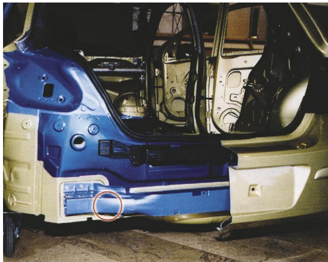
5. ábra: kocsiszekrény hátsó részének merevebbé tétele a felcsavart keresztartóval (körjelzés)
