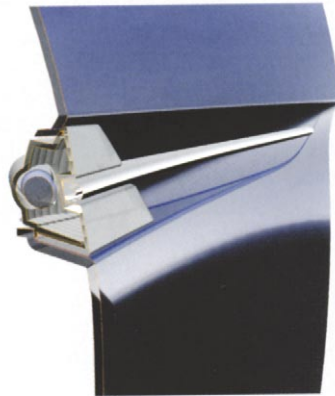
4. ábra: első, oldalsó irányjelző lámpa a díszítő elemmel, hőre lágyuló műanyagból
