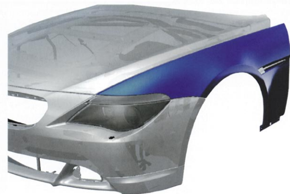
3. ábra: első, hőre lágyuló műanyagból készített oldalfal
