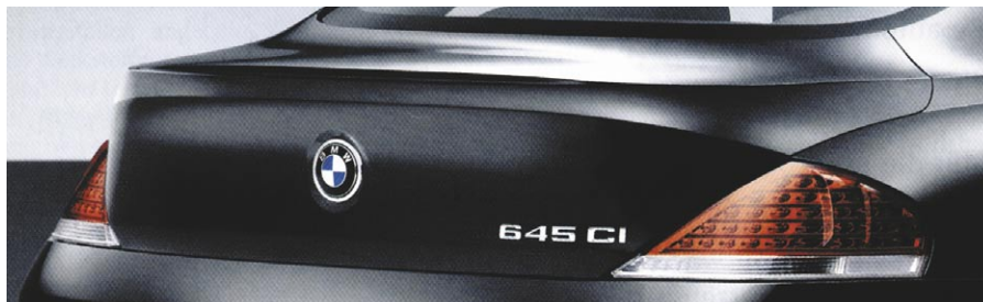
9. ábra: BMW 6-os Coupe fényezett és beszerelt csomagtartó fedele SMC műanyagból az egységes szegéllyel és hátsó részzel
