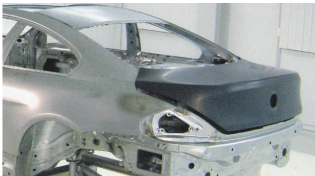
8. ábra: BMW 6-os Coupe SMC műanyagból készített csomag-tartó fedele
