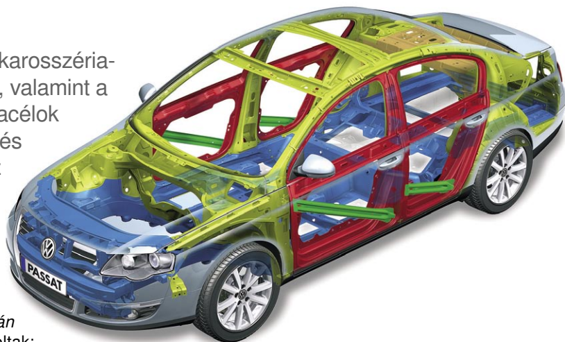
1. ábra: a VW Passat könnyűszerkezetes karosszériája
