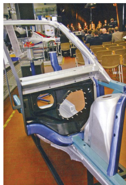
3. ábra: a motortér nézete, a hossz- és kereszttartó egyszerű összekötésével, hegesztve és MIG-forrasztással. A homloklemez anyaga magnézium, rögzítése ragasztás és szegecselés (K+F fotó)
