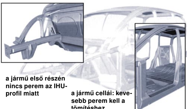
6. ábra: az NSB-nél több mint 10 kg tömeget megtakarítanak a peremek elhagyásával
