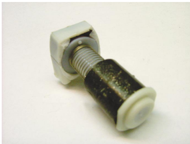
6. ábra: a reed kapcsoló mágneses gyűrűje és a rugó (a jeladó háza lebontva)
