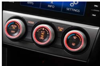
Kétfónás automata klímaberendezés
