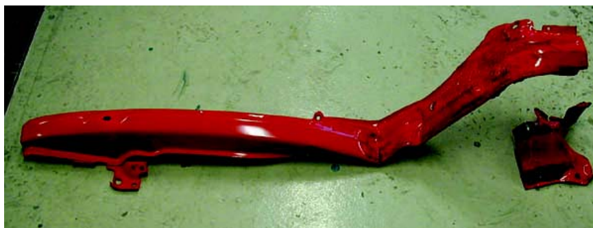
Utángyártott keresztmerezítő leszakadt tartólemezzel.
