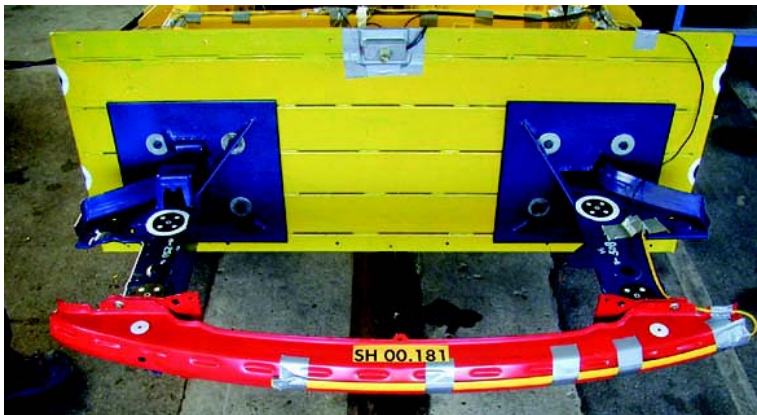
Utángyártott keresztmervítő strukturális vizsgálatának elrendezése.
