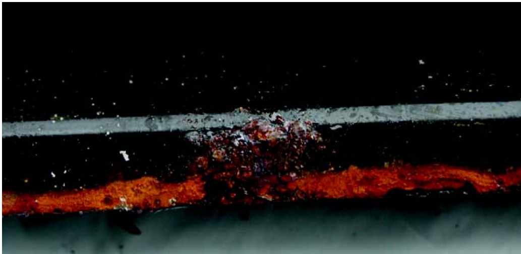
Rozsdás utángyártott kereszttartó.
