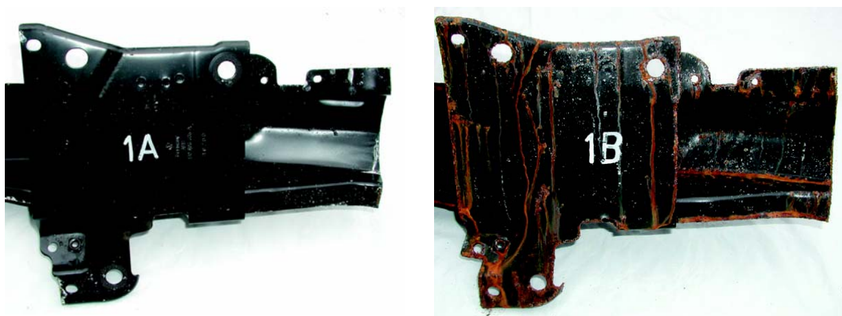
Az eredeti (balra) és utángyártott (jobbra) kereszttartó a gyorsított időjárás-álló próbán.
