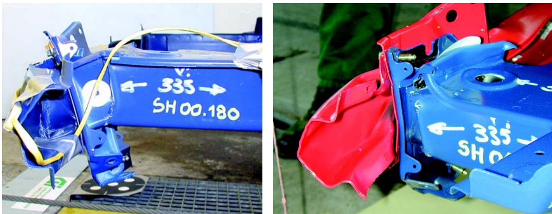
Az eredeti kereszttartó (balra), az utángyártott kereszttartó (jobbra): a vázkeret eredeti eleme súlyos alakváltozást szenvedett a kereszttartó törése miatt.
