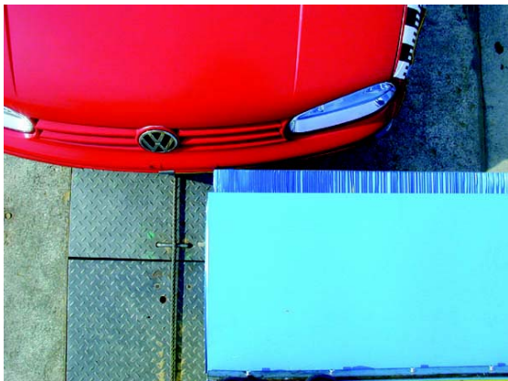
Vizsgálati elrendezés az 56 km/h ütközéshez.
