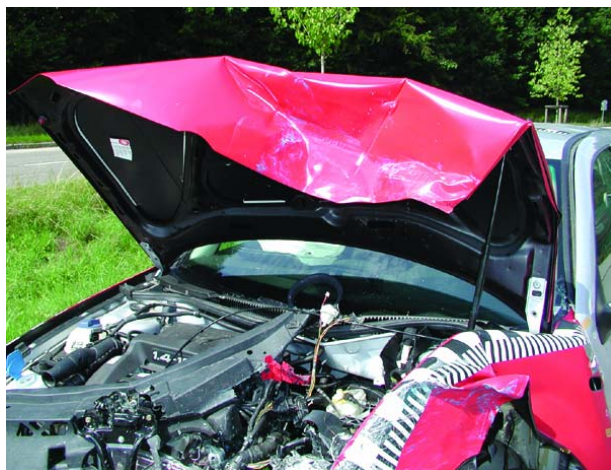
Az utángyártott motorháztető bejósolhatatlan gyűrődése
