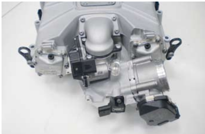
4 A motoros állítású fojtószelep és a by-pass szelep, előtérben a nyomás- és hőmérséklet-jeladó
