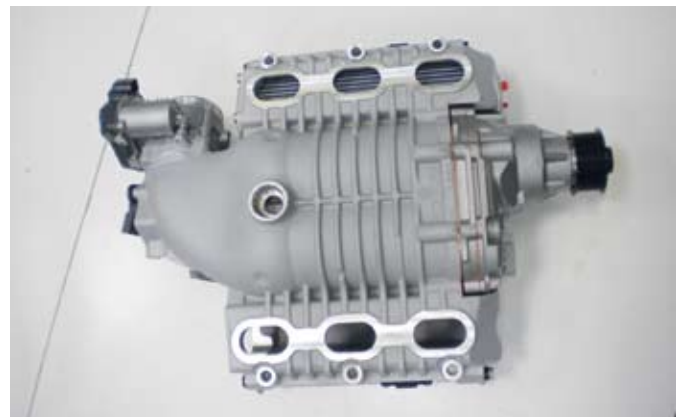
A töltőház alulnézete, a V6-os motor szívócsatornáinak csatlakozóperemei és az egyik soron a hűtőtömb is megfigyelhető, a középső nyílás a kartergáz-visszavezetés helye
