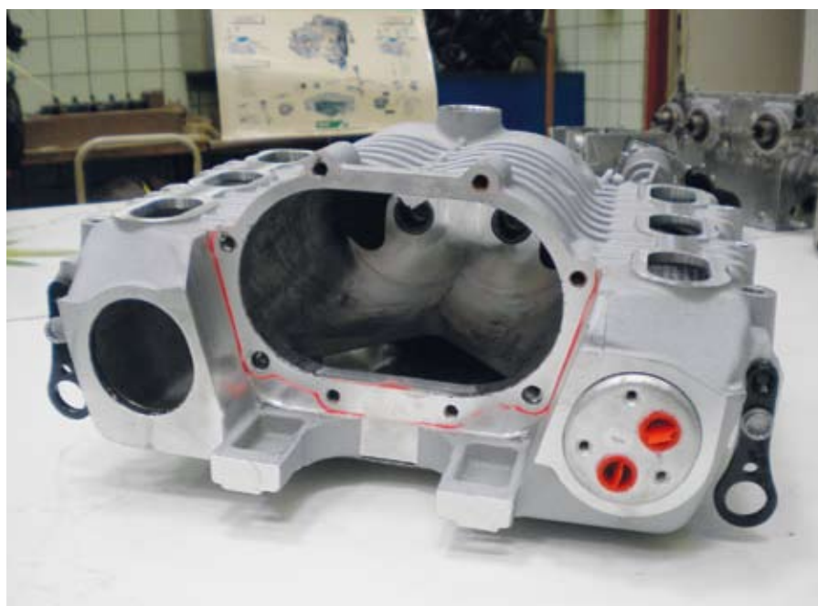
A Roots-fúvó háza, a házban a lapáttengely-csapágyak és a levegőbeömlő nyílás látható
