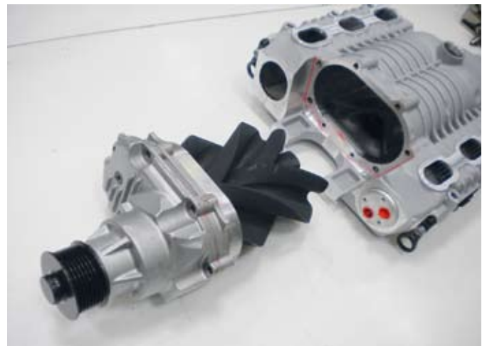
3 A fúvó házából a hajtó- és lapátkerékegység kihúzható
