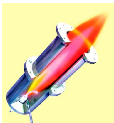
Egy kép a közeljövőből, plazmasugaras kipufogógáz-utókezelő, HCCI-dízelmotorhoz
