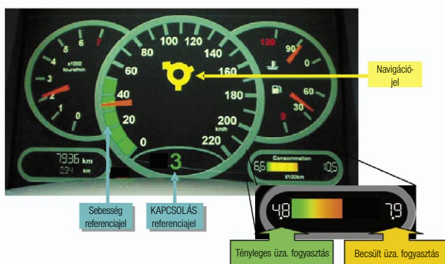
A CO 2 -csökkentést navigációs alapon végző fokozatkapcsoló működési elve
