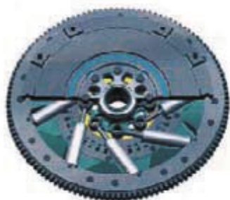
2. ábra: radiális, kettős tömegű lendkerék üres fokozatban
