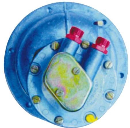
4. ábra: vákuumszivattyú, melynek membránmeghibásodása vezethet olajvesztéshez
