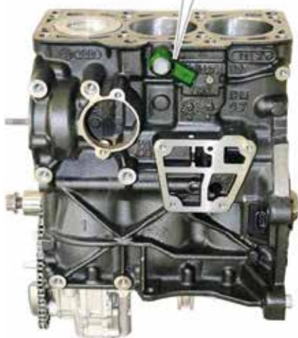
1 A szenzor a középső henger vonalában, a blokk tetején helyezkedik el
