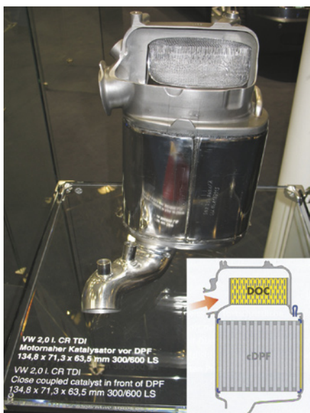
Az új CR TDI kipufogógáz-utókezelő rendszere. Az egy házba integrált oxidációs katalizátor (EMITEC) és részecskeszűrő
