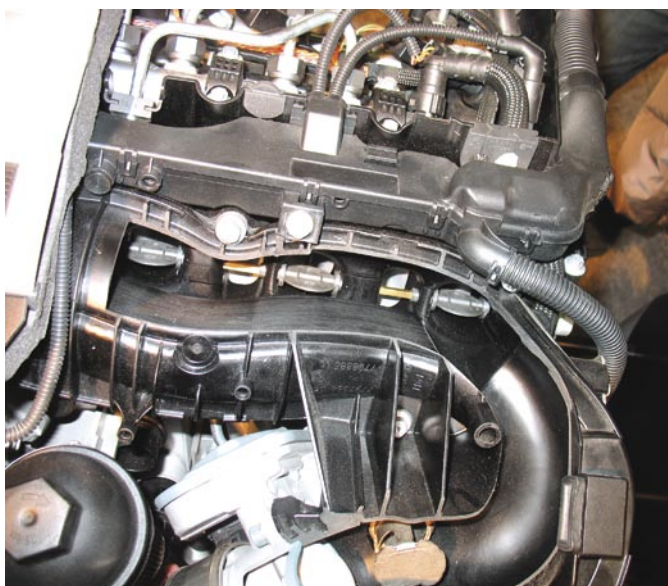
4. ábra: a szívócsatornában az örvénykeltő fojtócsappantyú
