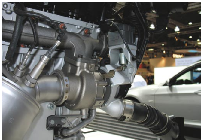
9. ábra: a VNT-töltő az állítóegységgel
