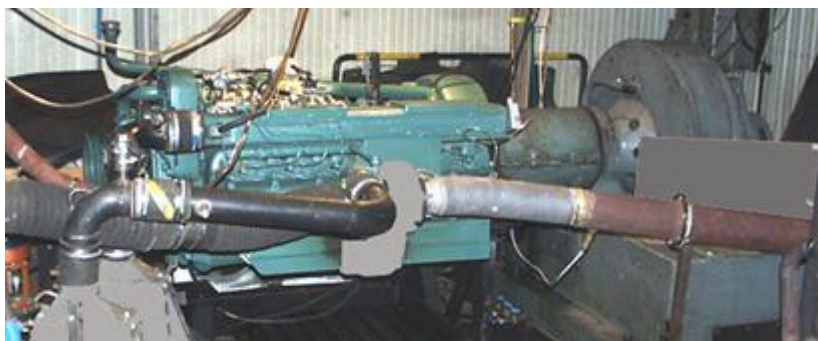
20. ábra. Nehéz haszonjármű motorja a teljesítménymérő motorfékpadon
