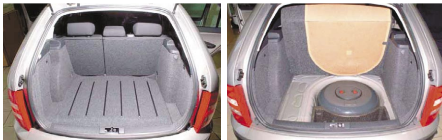
A Skoda Octavia gáztartálya helytakarékos módon, a csomagtartó padlólemez alatti pótkeréktartójának helyén kerül beépítésre
