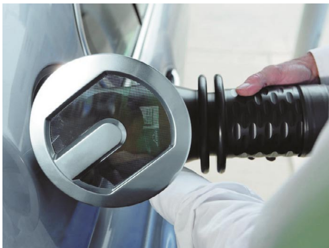
A H 2 -tartály szabványosított betöltőnyílása
