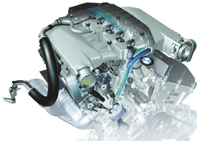
A Hydrogen7 motorjába juttatott üzemanyag útja hidrogénüzem esetén
