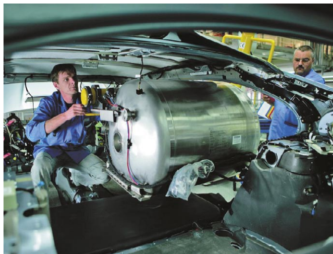
A Hydrogen7 kriogén H 2 -tartályának járműbe szerelése
