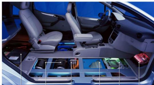
akkumulátor hidrogén-tartályok teljesítmény-elektronika tüzelőanyag-cella vezérlő egység villany-motor
