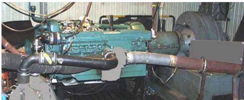
20. ábra. Nehéz haszonjármű motorja a teljesítménymérő motorfékpadon
