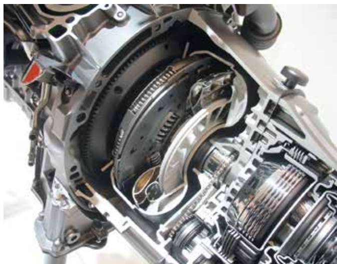
A hidrodinamikus nyomatékváltó metszete és a torzióslengés-csillapító
