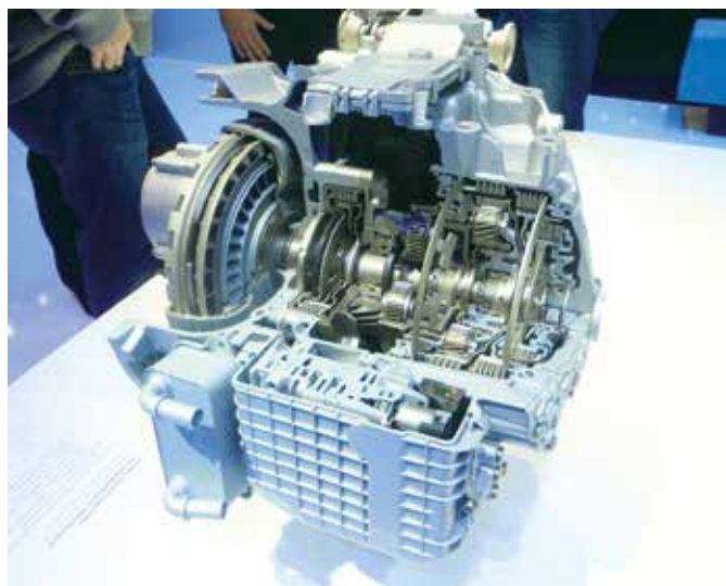
A hidromechanikus sebességváltó hidrodinamikusan nyomatékváltója és a bolygóműves mechanikus sebességváltó bolygóművei és lemezes fokozatváltó tengelykapcsolói figyelhetők meg a képen.
