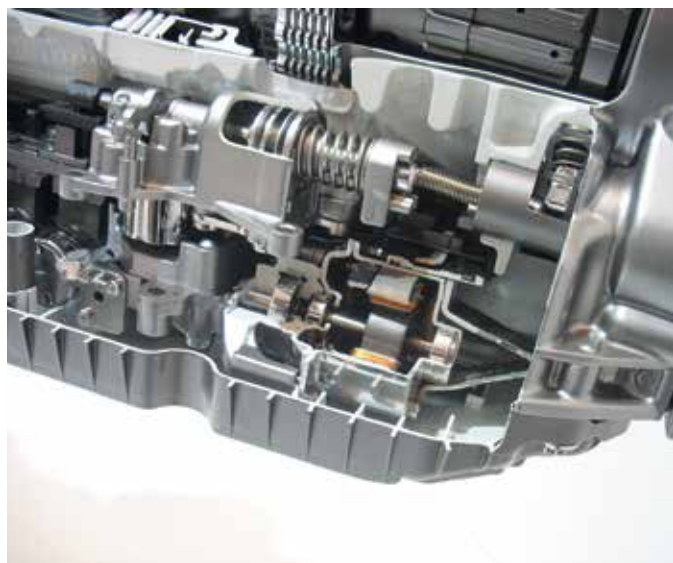
A rögzítőfék aktuátora és az elektromos hajtású olajszivattyú
