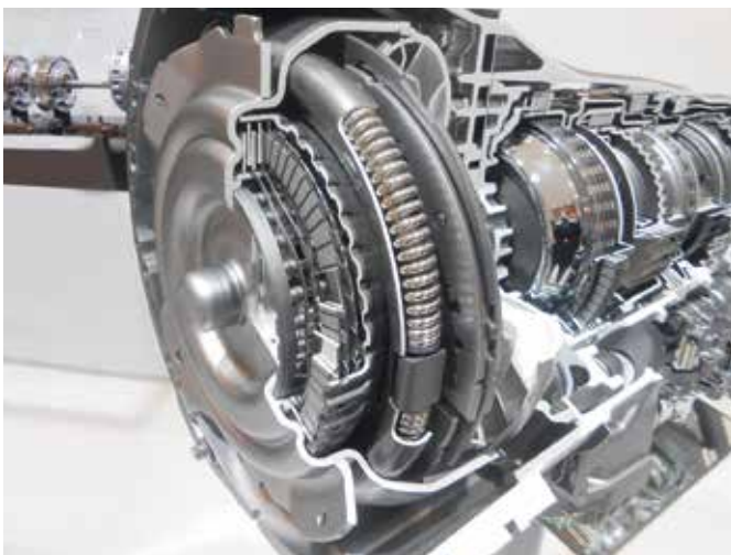
A váltó motoroldali nézete: a blokkírózó tengelykapcsoló és a rugós torzióslengés-csillapító
