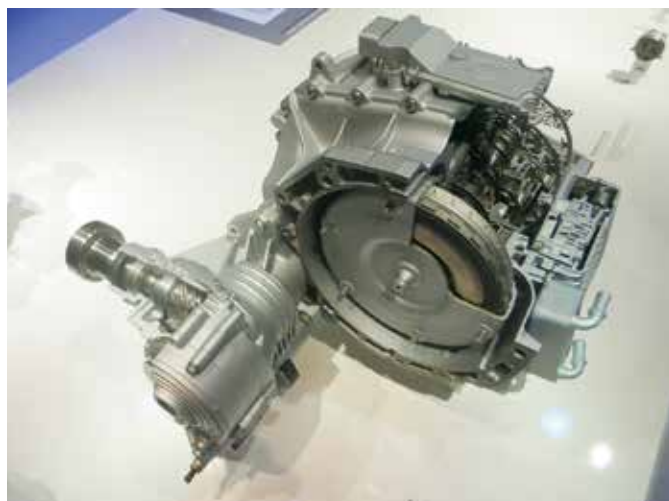
A 9HP konstrukciójában elöl, keresztben elhelyezett motorbeépítéshez illeszkedik. A váltó kihajtását ennek megfelelően a váltóház oldalán találjuk. A képek a differenciálművet és a hátramenő tengelyhajtást mutatják
