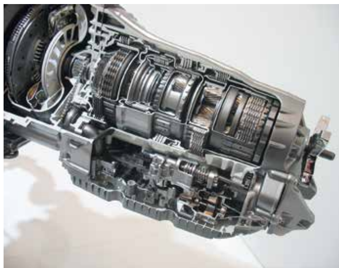
Az egyesített bolygóművek és a lamellás fokozatváltó tengelykapcsolók
