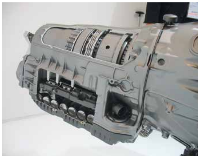
Az integrált mechatronikai modul és az elektrohidraulikus mágnesszelepek
