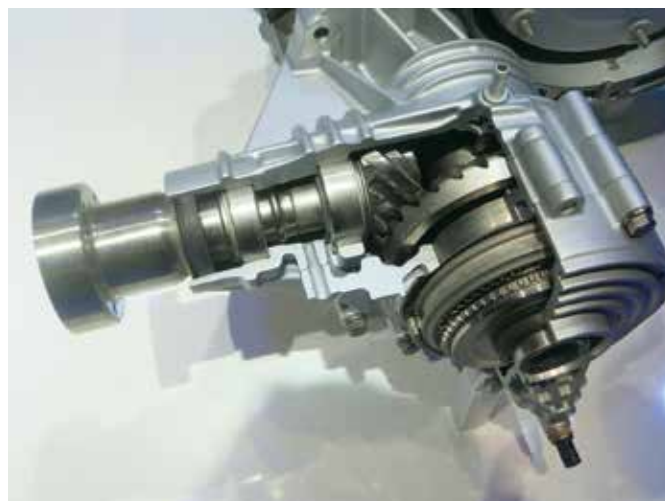
A 9HP konstrukciójában elöl, keresztben elhelyezett motorbeépítéshez illeszkedik. A váltó kihajtását ennek megfelelően a váltóház oldalán találjuk. A képek a differenciálművet és a hátramenő tengelyhajtást mutatják
