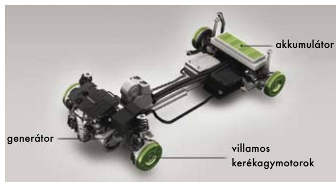
2. ábra: a Volvo tanulmányautójának a hajtásrendszere
