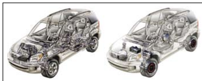
1. ábra: hobbi terepjáró „hagyományos” belső égésű és agymotoros kivitelben [1]
