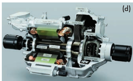
A Honda FCX Clarity hajtóelemeinek elrendezése (a és b), kerékgymotorja (c) és villamos hajtóegysége (d)
