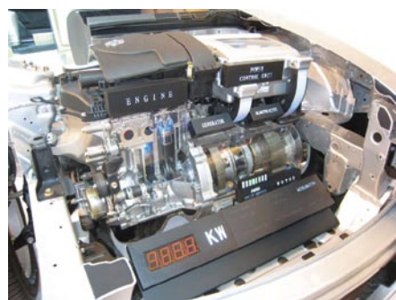
A tavaszi pekingi autókiállításon bemutatott kínai BYD, F3DM típusú PHEV-járműve még az idén gyártásra kerül. Képünk a jármű nyitott motorterét szemlélteti
