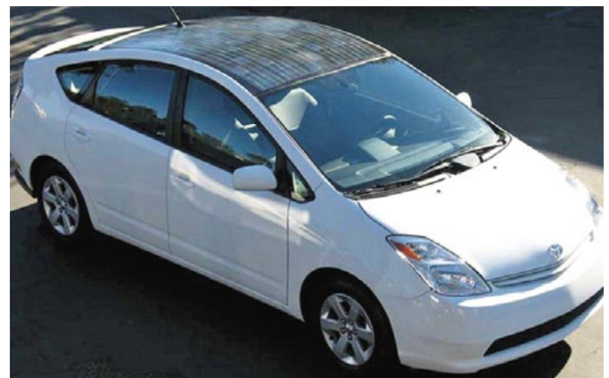
A Prius II tetőfelületére telepített napelemek néhány 100 wattos energiatermelése is segíti a jármű áramellátását
