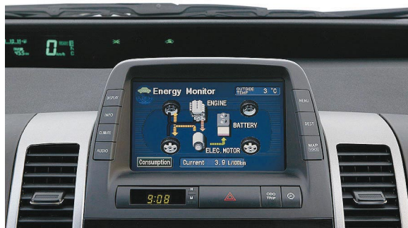
A Toyota Prius II műszerfali működésjelző monitora
