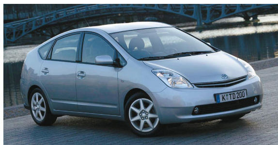
A Toyota Prius II kocsiszekrényét 0,26-os légellenállási alaktényező jellemzi
