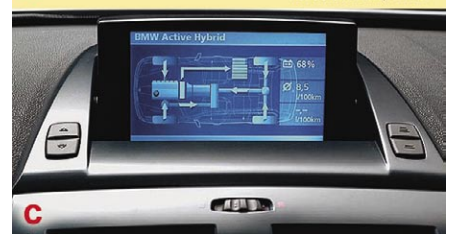
A BMW Concept X3 EfficientDynamics hajtásláncja (a), belső égésű, illetőleg villanymotorjának fordulatszám-nyomaték jelleggörbéi (b) és hajtásjellemzőinek műszerfalij kijelzője (c)
