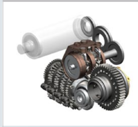
A Flybrid-rendszer és a hajtáslánc kapcsolata
