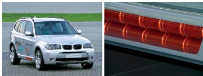
A BMW X3 Efficient Dynamics ultrakondenzátorai a jármű küszöbüregeibe kerültek beépítésre
