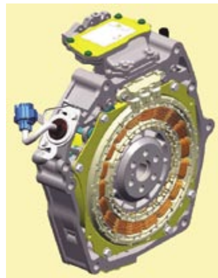
A Civic Hybrid integrált villamos hajtóegységének felépítése
