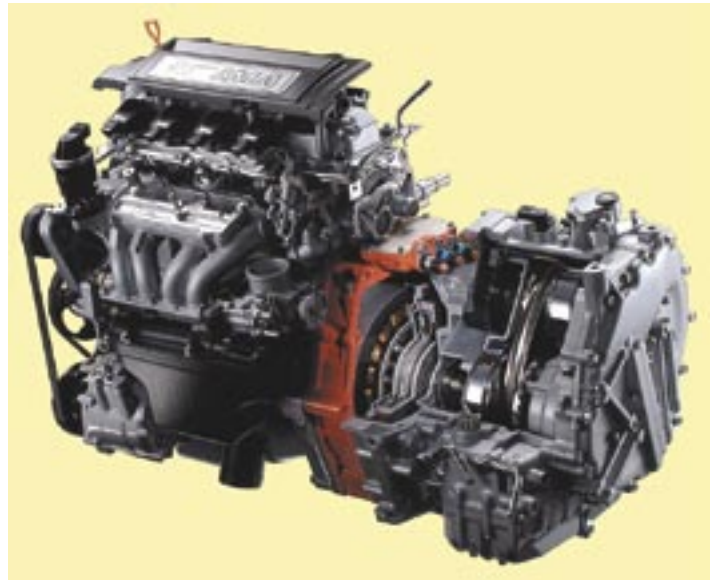
A 2003-as Honda Civic Hybrid integrált hajtóegysége négyhengerű soros motort, a motorra épített villamos gépet, és 5 fokozatú, kézi kapcsolású, vagy CVT sebességváltót foglal magába
