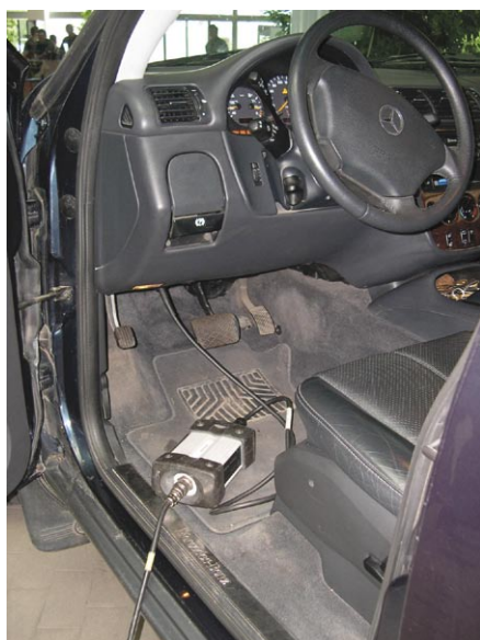
A diagnosztikai laptop illesztő áramkörrel csatlakozik a diagnosztikai csatlakozóhoz
