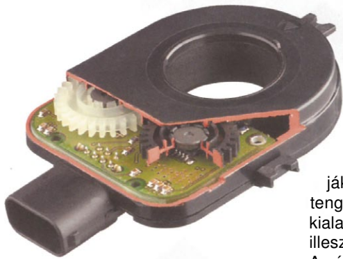
A második generációs kormánykerék elfordításérzékelője
