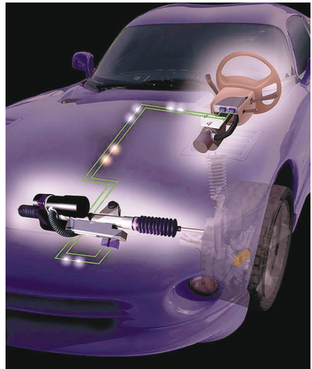
A jövő útja: a tisztán elektromos kormányzás (steer-by-wire)
