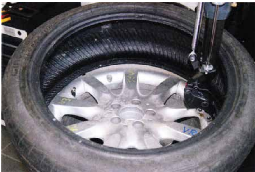
10 Felszereléskor a szelep kb. „4–5 óra” pozícióban legyen, amikor a szerelőfej elkezd a gumi peremét visszanyomni a keréktárcsába.
