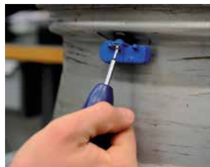
12 Ha a szelepet és a szenzort szereljük össze, ügyeljünk a megfelelő meghúzási nyomaték betartására.
