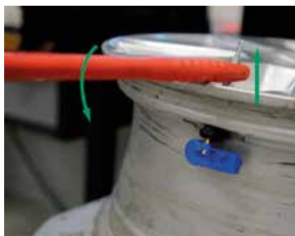
11 Az úgynevezett „snap in” szenzorok esetén a hagyományos szelepeknél is alkalmazott szerszámot kell használni.
