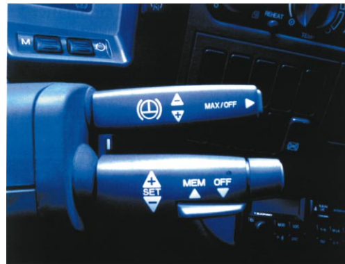
17. ábra: az aquatarder működtetése
