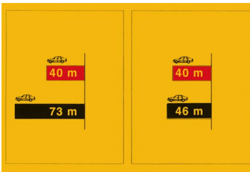
Lucas Varity (ma a TRW) elektronikus fékasszisztens
