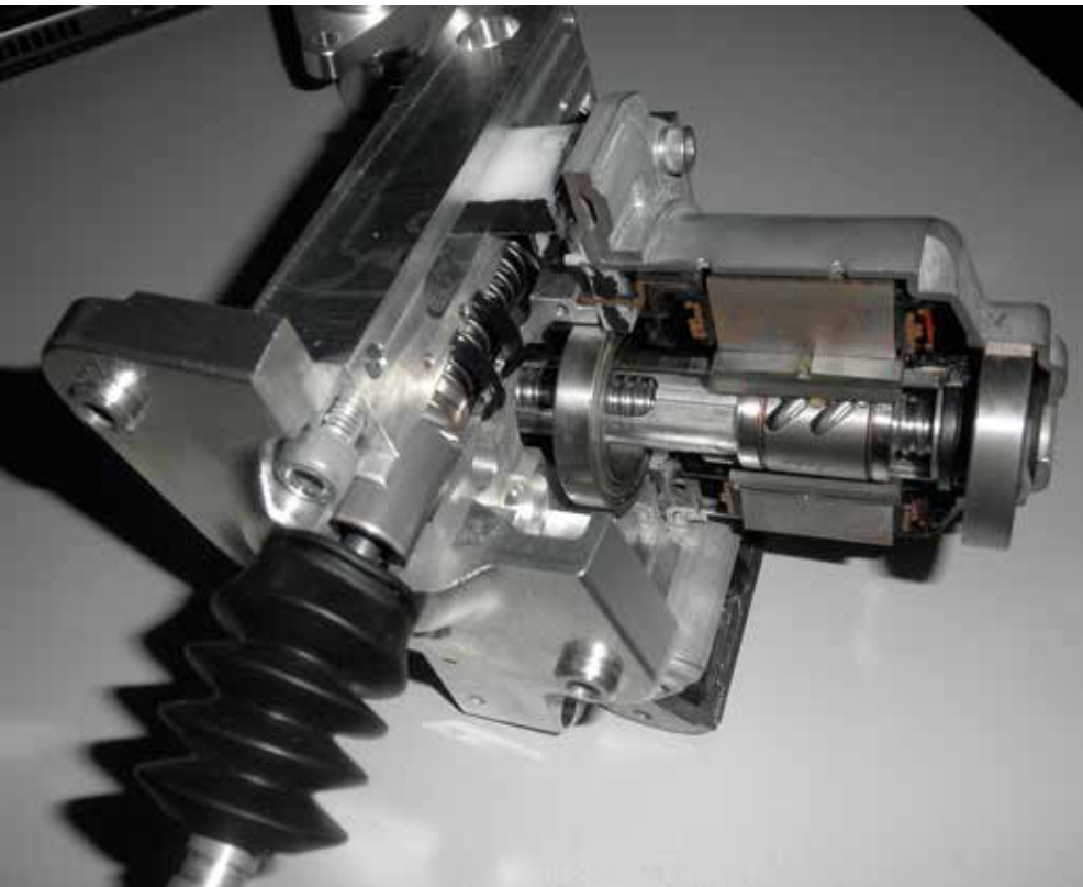
A Continental Teves MK C1 elektrohidraulikus fékezőegység metszete, előtérben a villanymotoros beavatkozó egység.
