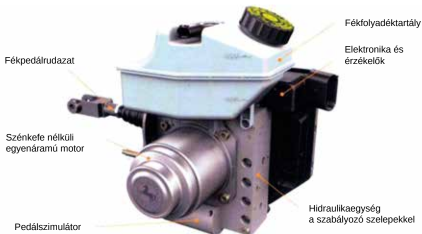
A Continental Teves MK C1 elektrohidraulikus fékezőegység részegységei.
