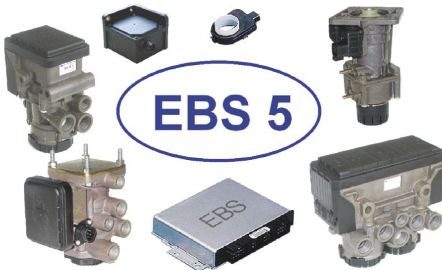
Az EBS 5 rendszer elemei: pedálmodul, egy- és kétcsatornás tengelymodul, elektronika, ESP-szenzorok
