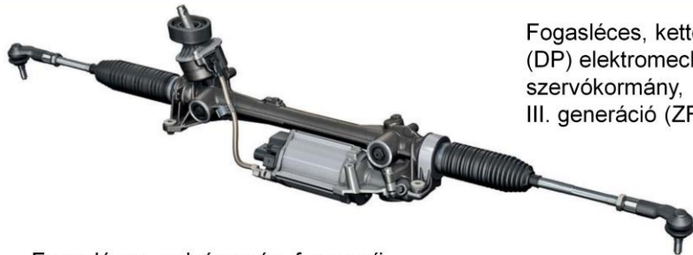
Fogasléces, golyósorsós, fogasszíf hajtású (APA) elektromechanikus szervókormány (VW-BS)
