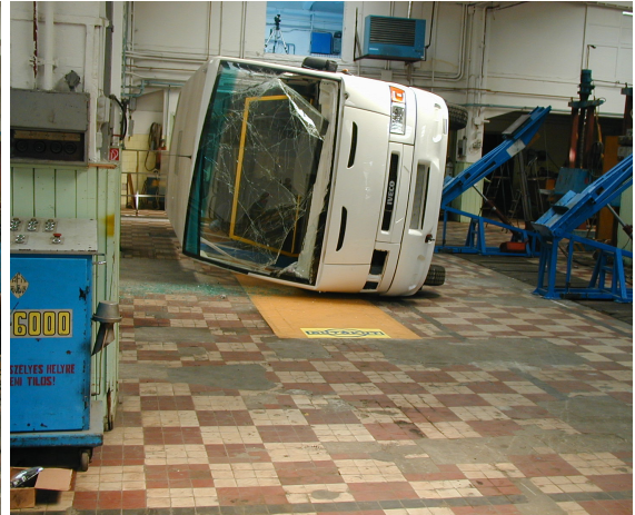
M4.8 ábra A borítóvizsgálat befejezése utáni állapot
