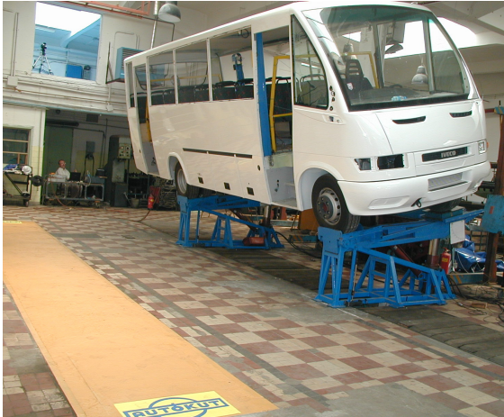
M4.7 ábra A borítóvizsgálat kezdete
