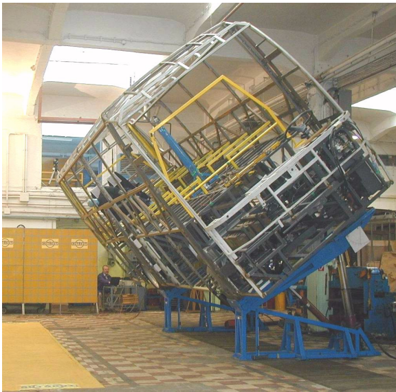
M4.13 ábra A vizsgálatra felkészített váz-szerkezetű Marbus B3 modell-autóbusz súlypont megállapítási előkísérlete
