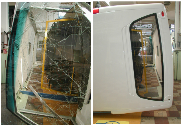
M4.9 ábra Az autóbusz belseje az összetört első szélvédőn keresztül (A túlélési tér sértetlen maradt) A hátsó szélvédő kitérés nélkül vészelte át az ütközést, a második ajtóoszlop felső sarokpontjának maradó deformációja mindössze 10 mm volt
