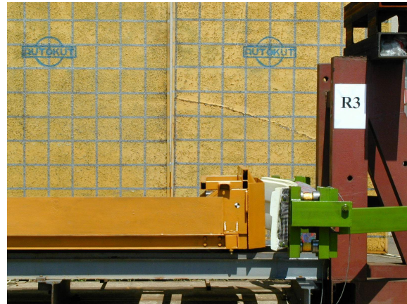
Hátsó, rugalmas lökhárító (R3) ütközésvizsgálata
