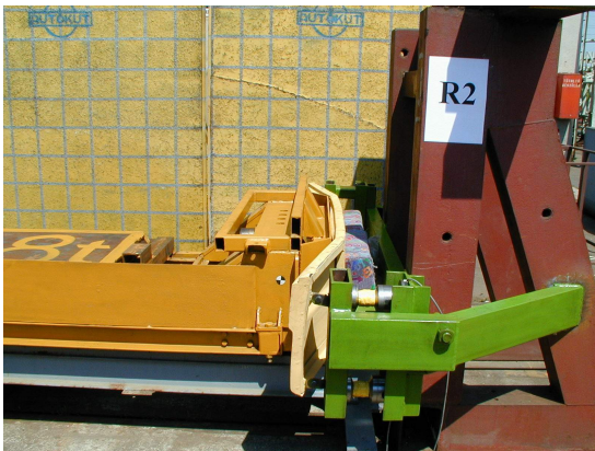
Hátsó, héjszerkezetű lökhárító (R2) ütközésvizsgálata
