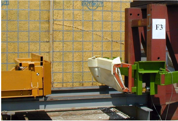
Melső, epoxigyantával töltött lökhárító ismételt (F3) ütközésvizsgálata
