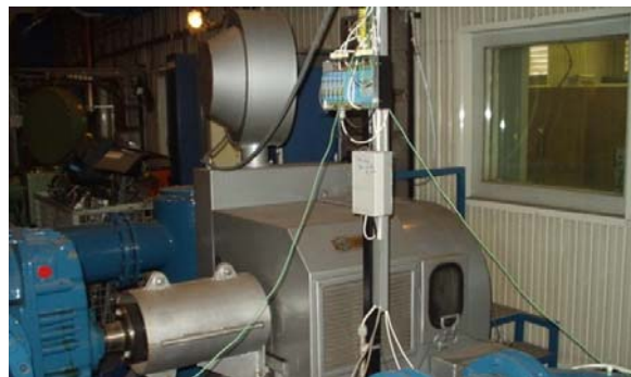
25. ábra. A részecskevizsgálathoz használt kipufogógáz-hígító és mintavevő rendszer légszivattyúi
