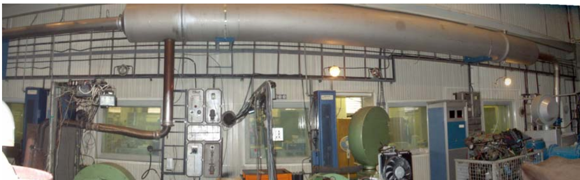
24. ábra. A részecskevizsgálathoz kialakított kipufogógáz-hígító és -mintavevő rendszer
