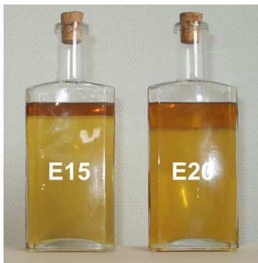
19. ábra. A 4 hónapos állásidő alatt szétvált 15 és 20 % etanolt tartalmazó keverékek
