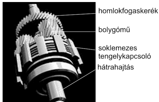
6. ábra: a VTD All-Wheel Drive rendszer homlokerekes bolygóműve és differenciálzárja
